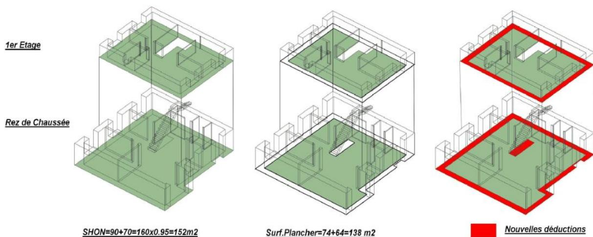
Figure 3 : Schéma explicatif de la surface de plancher
